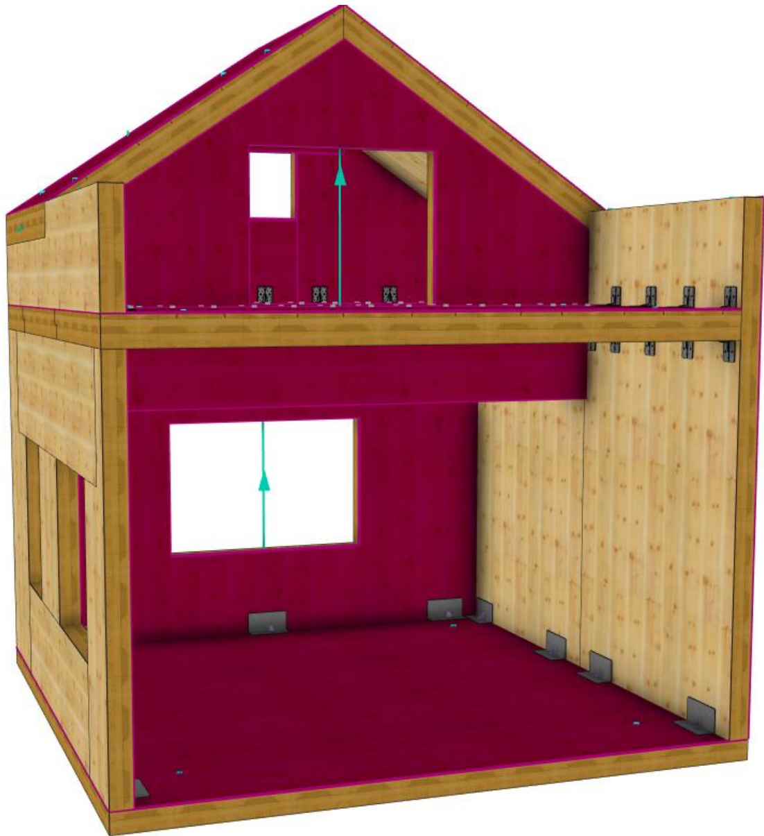
Imagen 3: Modelo 3D de la vivienda, con las geometrías preparadas para su exportación a CNC. Cada panel lleva sus capas exteriores orientadas en la dirección correcta, y las calidades de las capas exteriores están bien identificadas.
